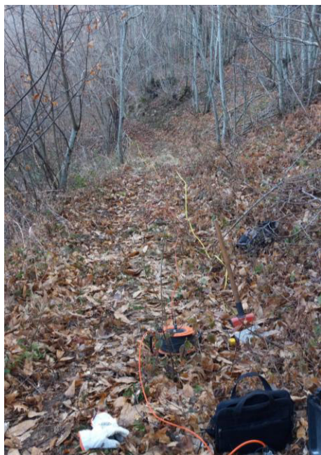
Stendimento geofonico per indagine geofisica tipo sismica a rifrazione in onde P (B2) e MASW (MASW2)
