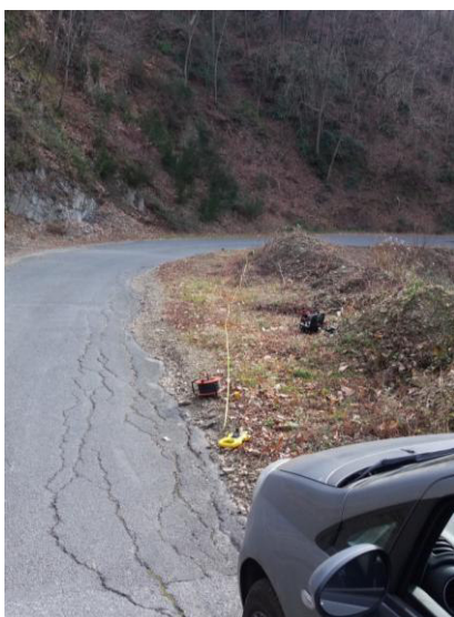
Stendimento geofonico per indagine geofisica tipo sismica a rifrazione in onde P (B1) e MASW (MASW1)
