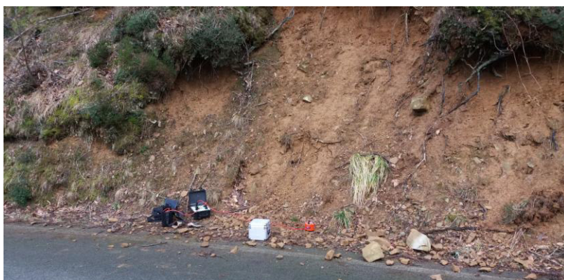
Stendimento geofonico per indagine geofisica tipo sismica a rifrazione in onde P (B1) e MASW (MASW1)
