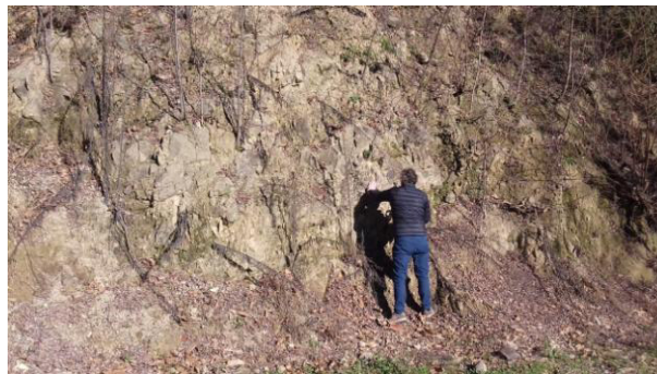
Nel tratto finale del fronte 8 è stato impossibile effettuare il rilievo geomeccanico per l'estrema fatturazione ed alterazione del substrato roccioso.
