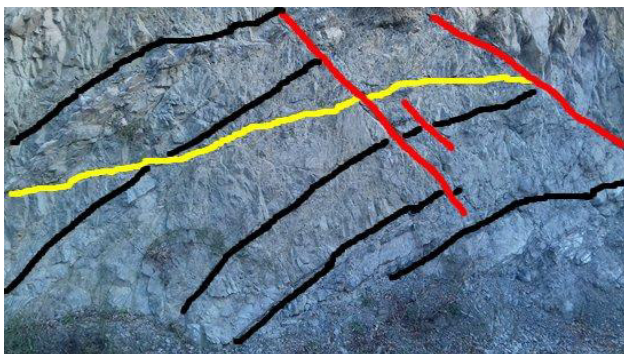
Stratificazione in nero e due diverse famiglie di discontinuità; le discontinuità di colore rosso presentano una immersione ed una inclinazione pari a 150^{\circ}/54^{\circ} mentre le discontinuità di colore giallo pari a 330^{\circ}/28^{\circ}
