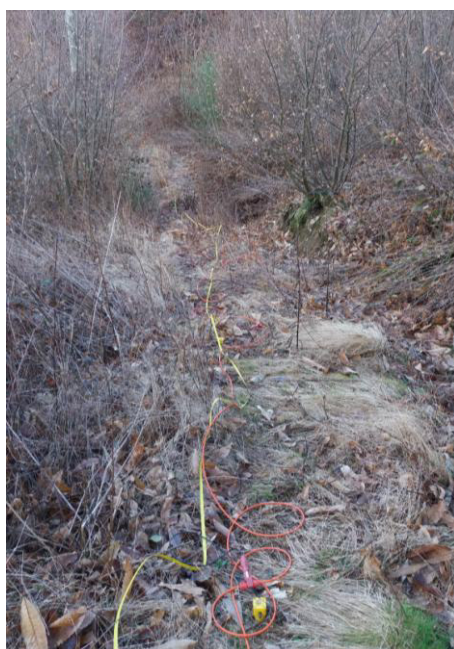
Stendimento geofonico per indagine geofisica tipo sismica a rifrazione in onde P (B3) e MASW (MASW3)
