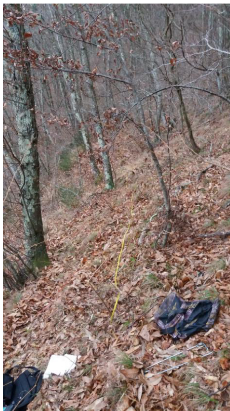
Stendimento geofonico per indagine geofisica tipo sismica a rifrazione in onde P (B2) e MASW (MASW2)
