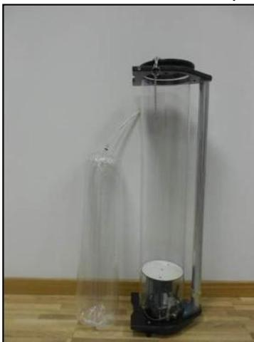
Per la misura della concentrazione di sorgenti convogliate, il campionatore passivo è usato per prelevare le arie direttamente dall'interno del camino utilizzando il punto di prelievo ufficiale predisposto per legge.
