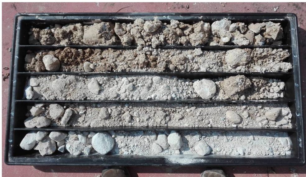
FOTO 3: STRATIGRAFIA DA 5 A 10 M DEL SONDAGGIO S1.
