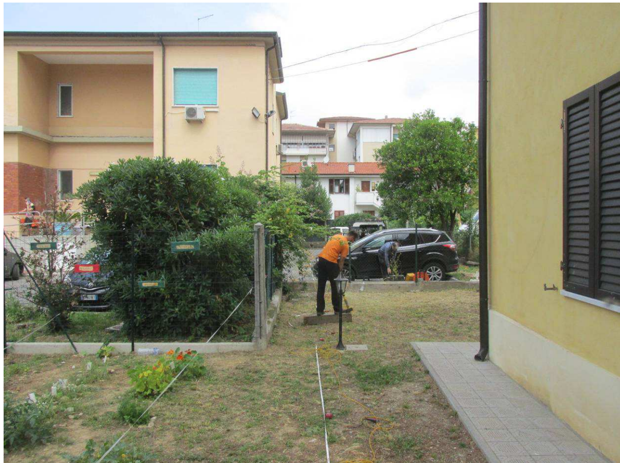
Foto 3 Fase di energizzazione dello stendimento sismico “Via Galileo Galilei 1-1’ (onde SH)”.
