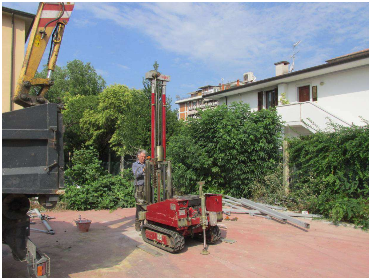
Foto 2 Prova penetrometrica dinamica superpesante DIN2.
