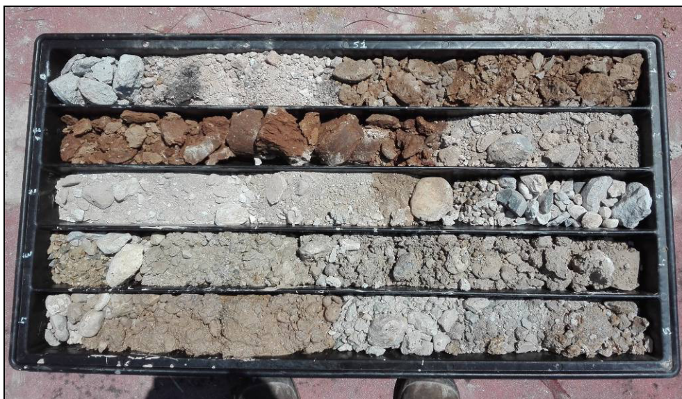
FOTO 2: STRATIGRAFIA DA 0 A 5 M DEL SONDAGGIO S1.
